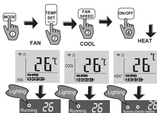
1. Если для вас некомфортны условия, создаваемые в автоматическом режиме, выберите вручную желаемый режим работы с помощью кнопки MODE: Охлаждение (COOL), Обогрев (HEAT) или Вентиляция (FAN).
