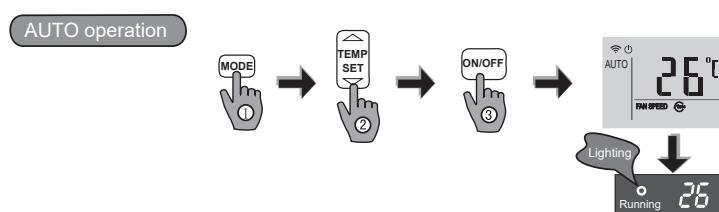
При выборе Автоматического режима работы (AUTO), кондиционер самостоятельно устанавливает режим работы: охлаждение, обогрев, или только вентиляция в зависимости от выбранной вами температуры и температуры в помещении. Установленный вами режим работы фиксируется в памяти микрокомпьютера внутреннего блока, поэтому при повторном включении кондиционера, прибор начинает работать с ранее установленными настройками.
