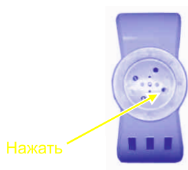
Рис.3. Расположение штока на термовыключателе термостата
