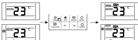
Для подтверждения настроек таймера нажмите еще раз кнопку «ТАЙМЕР» и после этого индикация перестанет мигать. После настроек включения таймера пользователь может выбирать скорость вентилятора, режим работы, температуру, поворот жалюзи.
