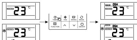
Время по умолчанию устанавливается 0,5ч. С помощью кнопок регулирования можно изменить время. Если в течение 10 секунд не было нажатия кнопок настройки таймера сгорят и прибор выйдет из данного режима работы.
