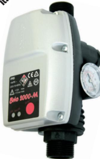
**Реле давления-автомат «BRIO 2000-M»** (производство концерна ITALTECNICA, Италия) — устройство со встроенным манометром и датчиком протока, позволяющее автоматизировать включение и выключение однофазных электрических насосов, мощностью до 1,5 кВт.
